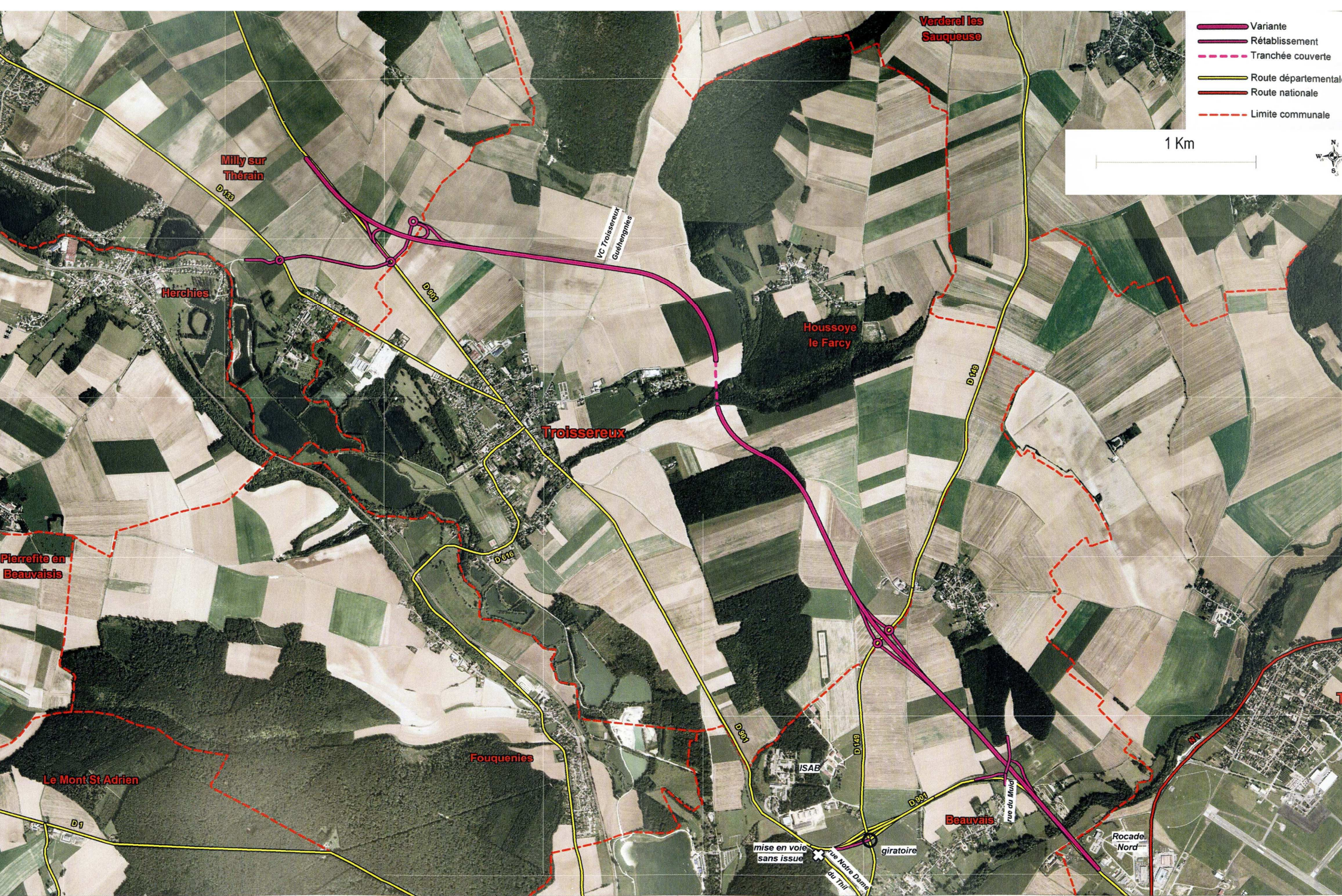
VARIANTE N°10 - TRANCHÉE COUVERTE
